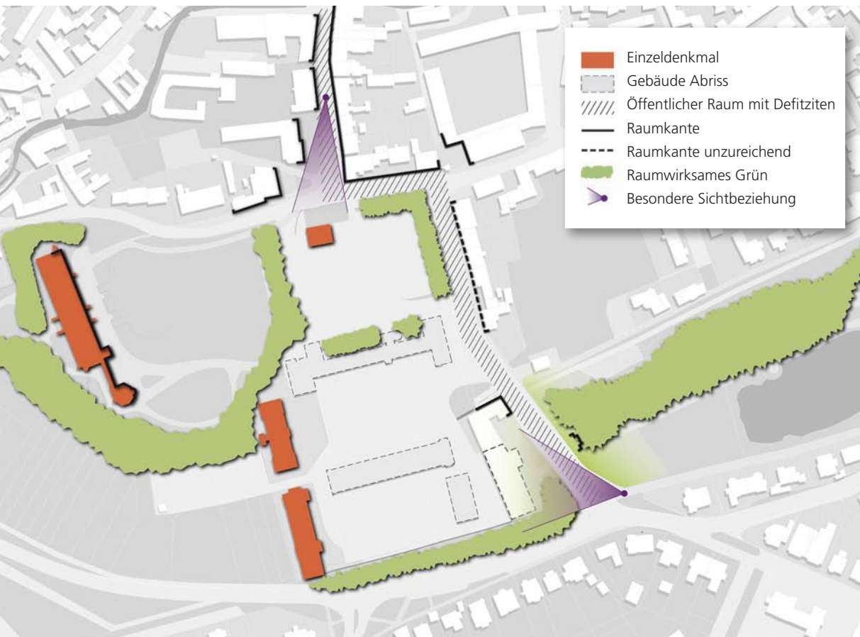
Abb. 19: Räumliches Gefüge des Pfalzquartiers
