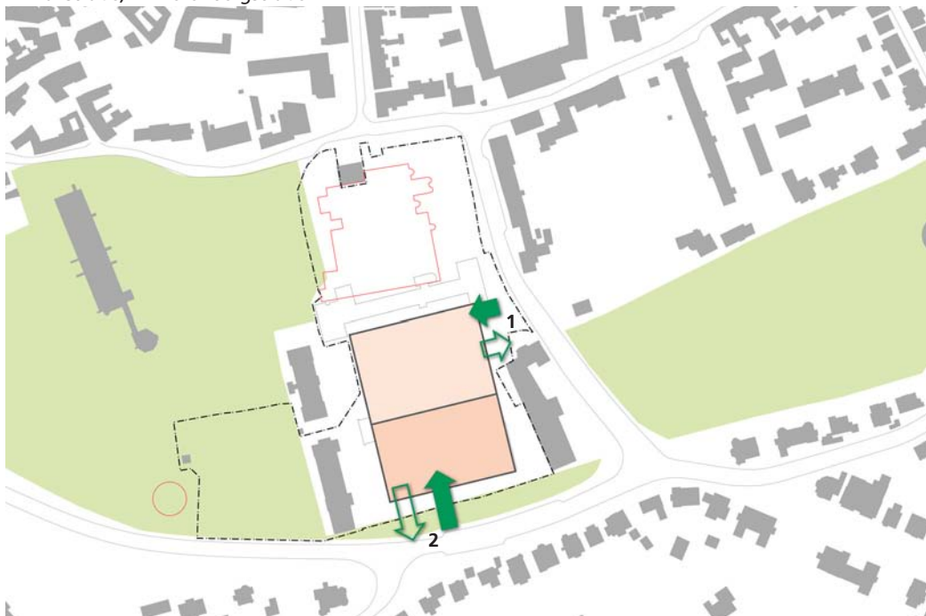
Abb. 36: Positionierung der Tiefgarage. Untersuchte Zufahrtmöglichkeiten 1: Wallstraße, 2: Werenbergstraße
